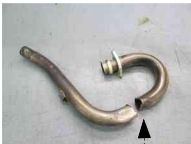
**4st** は小径パイプですから、凹み部分を切断して修復します。
