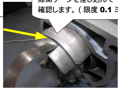
・シリンダーとピストンの隙間確認
